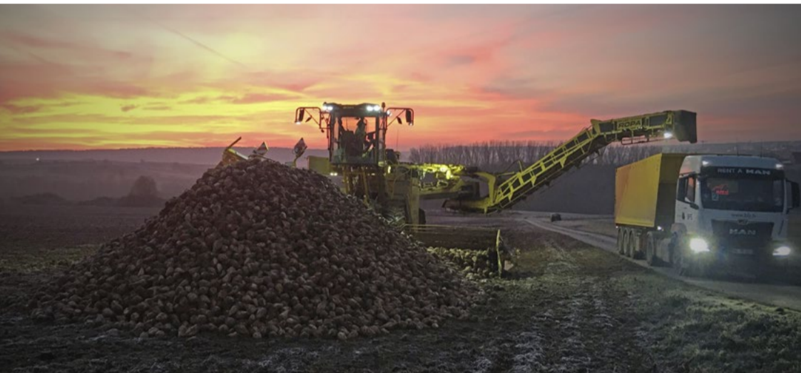
Rübenernte ist immer Teamarbeit. Mit dem Ladegerät Maus werden die Rüben auf die Auflieger befördert und mit dem BFS-Fahrzeug abtransportiert.
